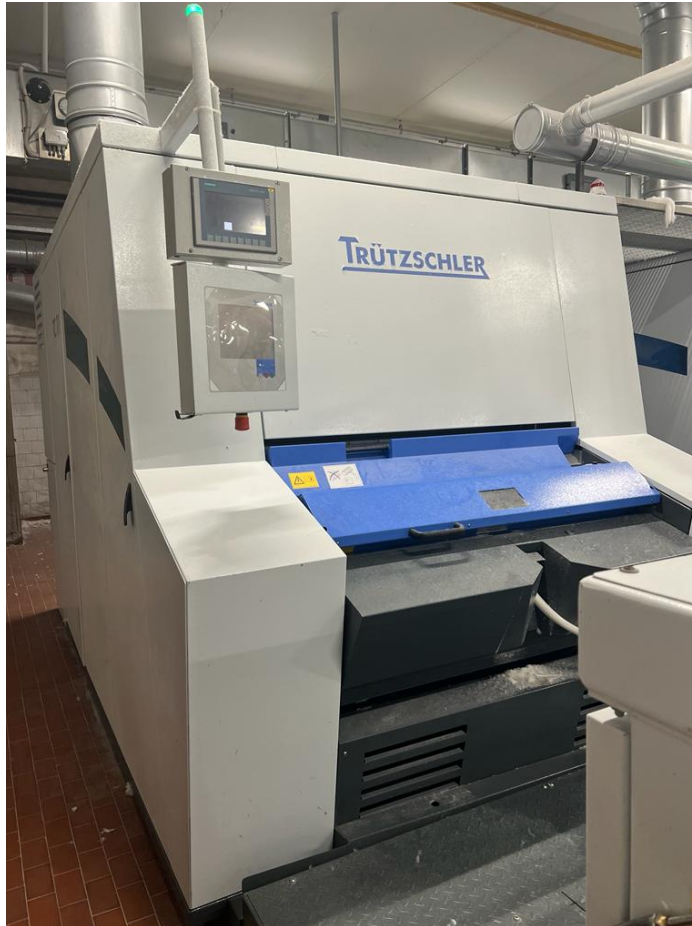
Foto 2 – Imagem da máquina de carda TC11, marca Trützschler.
